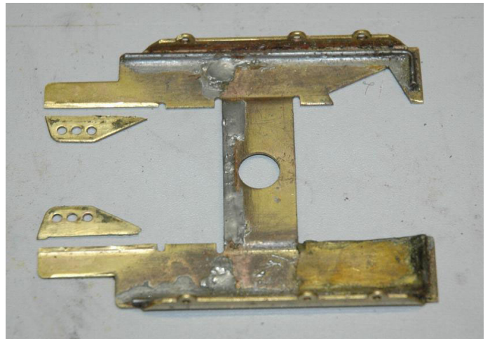
Chassiset er skilt ad, og her ses den forstærkede H-sektion med forakselholderne fjernet fra chassiset!
