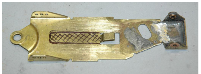
Midtersektionen, hvor det skraverede område evt. kan fjernes for at lette chassiset!
