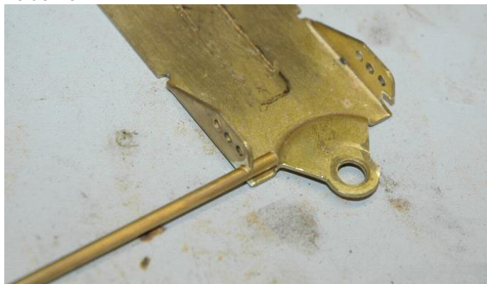
Herefter loddet et 1,5 mm rør i hakket i hver side!
