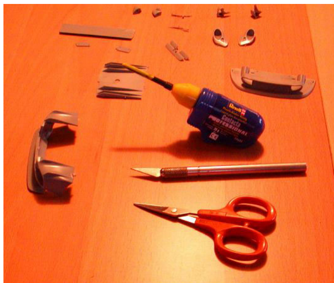
En skalpel, en lille saks og plastiklim er alt, der skal til for at samle en body!
