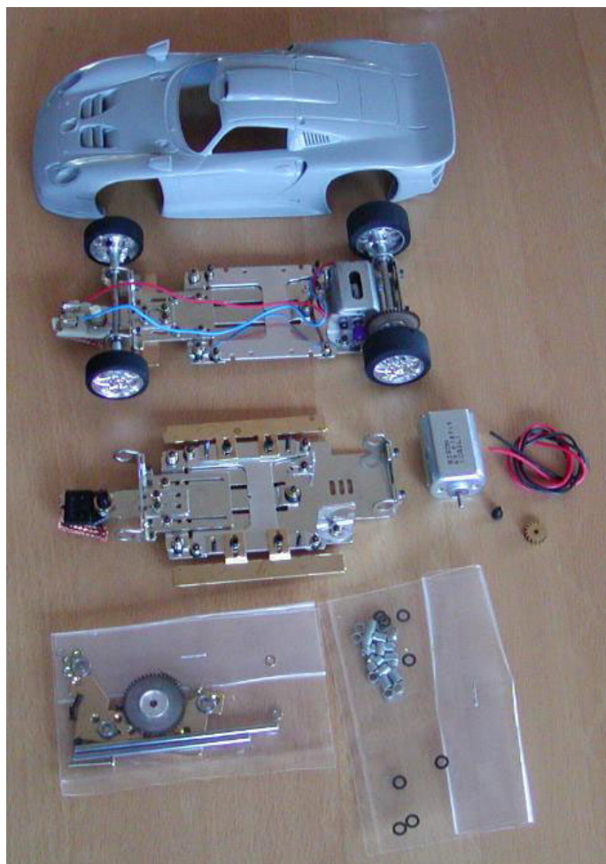
Nederst chassiset, som det ser ud, når man købet det. Øverst er det monteret med hjul, Fox-motor, gear, en anden guide og vægtsættet. Desuden er det øverste chassis justeret ind til en Ferrari 599, der er lidt længere end den Porsche, vi bruger her til artiklen.
