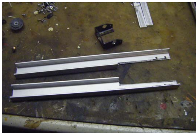
De 2 U-profiler er skåret til og klar til at få motorholderen monteret!
